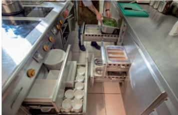
La cuisinière centrale de production suisse, avec plaque de cuisson double en Ceran qui peut se transformer en plaque de maintien thermique, deux plaques de cuisson à induction sur toute la surface et une plaque Swiss Indu Griddle constitue le cœur de la nouvelle cuisine. Les blocs inférieurs sont équipés de tiroirs chauffants et réfrigérants.
