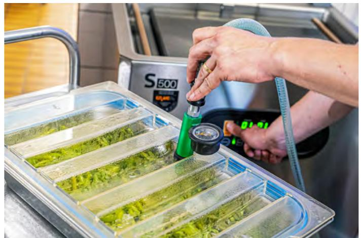
Die Gerichte werden heiss in GreenVac-Schalen abgefüllt, verschlossen, im FrigoJet schnellgekühlt und anschliessend direkt in den Schalen vakuumiert, das verbessert die Qualität und verlängert die Haltbarkeit.
