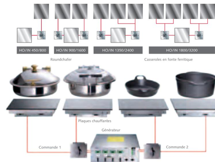
Un seul générateur permet de faire fonctionner jusque quatre plaques chauffantes simultanément. Le type de générateur est choisi en fonction du nombre de plaques souhaité, de une à quatre. A partir de deux plaques chauffantes, il est possible de prévoir deux circuits séparés contrôlés chacun par leur propre régulateur de température en continu. Un circuit de ventilation performant maintient le générateur à la température de service même en cas d'utilisation de longue durée.
